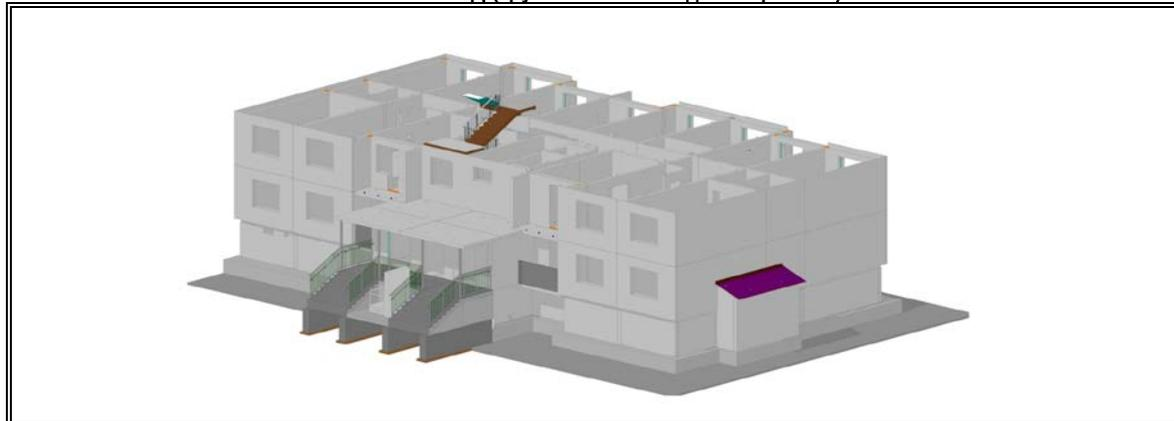
На заводе внедрена система крупнопанельного домостроения. Особенностью данной системы является возведение зданий из заранее изготовленных крупноразмерных плоскостных элементов стен, перекрытий, покрытий и других конструкций. Строительство зданий из крупных панелей позволяет существенно сократить сроки возведения зданий, снизить стоимость строительства и повысить производительность труда.
